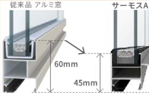
ガラスの空気層を拡大し、断熱性を向上
